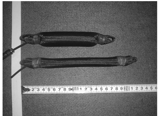
図1 McKibben 型空気圧アクチュエータの外観 ((株) 日立メディコ製)
