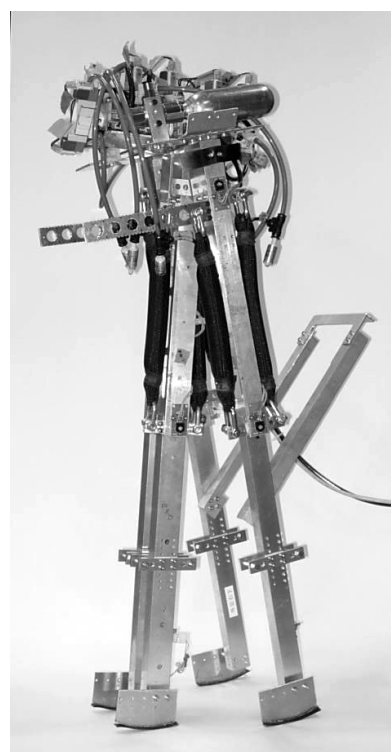
第2図 大阪大で開発された空気圧駆動二足歩行ロボット空脚(Que-Kaku)
