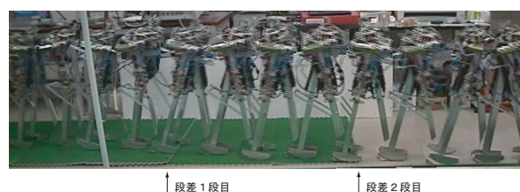
第3図 「空脚」が2段の段差を歩行する様子
