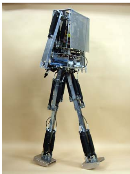
図 1:McKibben 型人工筋を用いた二足歩行ロボット
