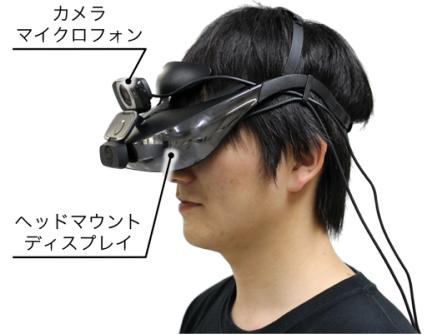
図 7 ヘッドマウントディスプレイ型 ASD 知覚体験シミュレータ。カメラとマイクロフォンから入力された視聴覚信号を実時間で処理し、ヘッドマウントディスプレイ上に ASD の視覚世界を再現する。本シミュレータを用いることで、ASD の特異な知覚が社会的行動に与える影響や、脳活動に与える影響を調べることが可能となる。
